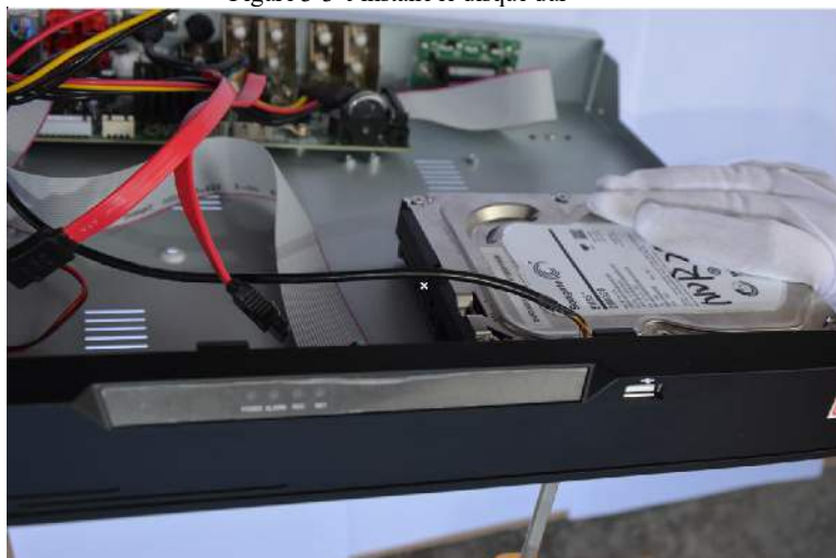
Figure 3-3 J'installe le disque dur
