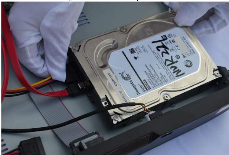
Figure 3-4 J'installe le disque dur
